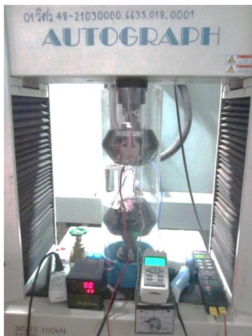
รูปที่ 6 ชุดควบคุมอุณหภูมิหลังจากประกอบกับเครื่องทดสอบแบบอเนกประสงค์แล้ว
