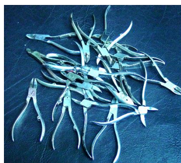
ภาพที่ 2 กรรไกรตัดกระดูกที่ชำรุดไม่มีสปริง
