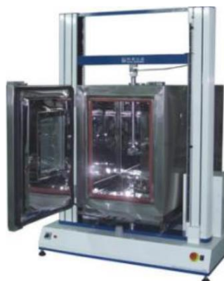
รูปที่ 3 เครื่องทดสอบสมบัติการยึดติดแบบอเนกประสงค์ที่ความชื้นและอุณหภูมิต่างๆ
