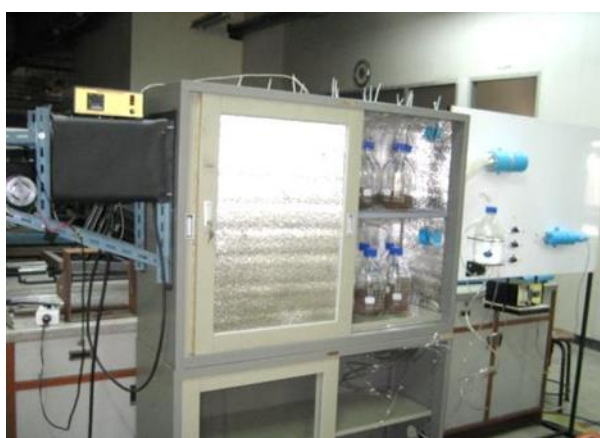
ภาพที่ 2 เครื่องทดสอบที่สร้างขึ้นเพื่อการทดสอบ พลาสติกชีวภาพ
