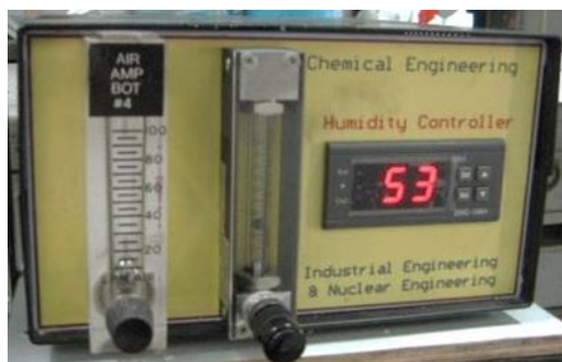
ภาพที่ 6 แสดงเครื่องควบคุมความชื้น
