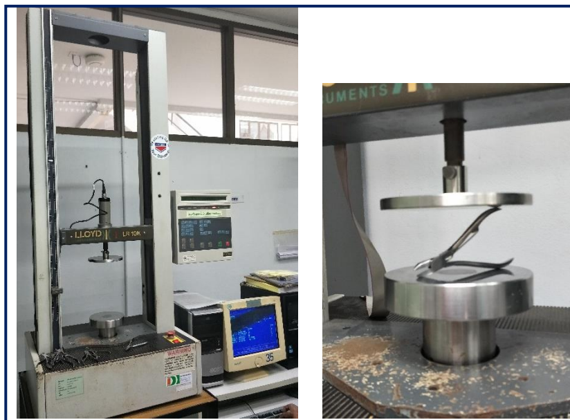
ภาพที่ 7 การทดสอบความต้านทานแรงกดของสปริงที่ประยุกต์เทียบกับของเดิม
