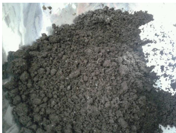
ภาพที่ 14 ตัวอย่างพลาสติกชีวภาพผ่านการทดสอบด้วยระบบการย่อยสลายพลาสติกชีวภาพ กลายเป็นชีวมวล น้ำและก๊าซคาร์บอนไดออกไซด์
